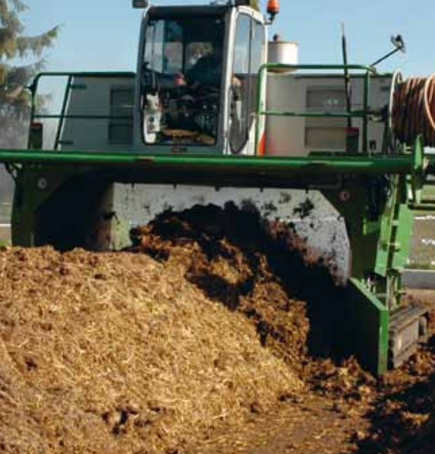
La retourneuse d'andains réoxygène le fumier, dont la paille est ensuite décomposée rapidement par les micro-organismes.
